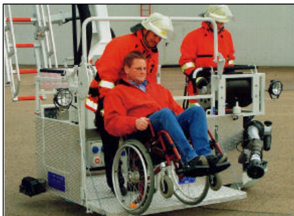
Bild 11: Zugang über Vorbauplattform: Sicheres und rückengerechtes Retten auch von Rollstuhlfahrern ist möglich (Quelle: IVECO Magirus)
