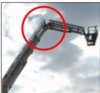
Bild 30: Gefährlicher Überstieg im Gelenkbereich
