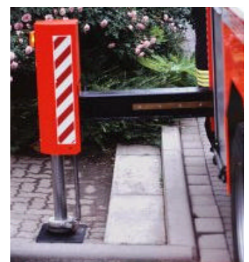
Bild 23: Waagrecht-Senkrecht-Abstützung der Drehleiter
