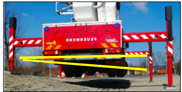
Bild 27: Niveaueingleich durch Abstützung beim Teleskopgelenkmast
