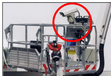
Bild 32: Kamera zur sicheren Steuerung und Überwachung der Bühne vom Hauptsteuerstand am Fahrzeug
