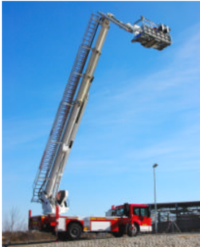
Bild 17: Teleskopgelenkmast (Im Bild: IVECO Magirus ALP 320 L)
