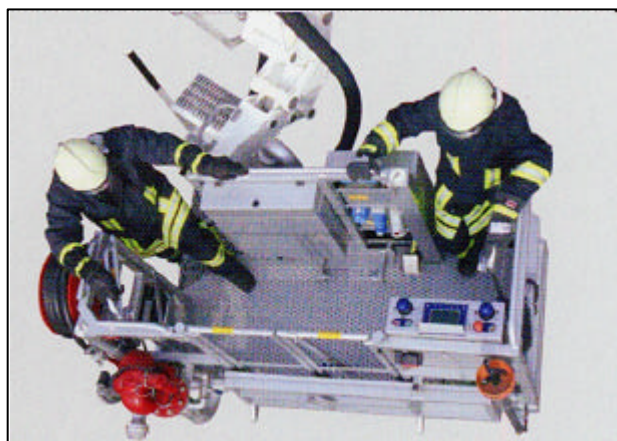
Bild 10: Arbeitsbühne eines Teleskopgelenkmasts (Quelle: Metz)
