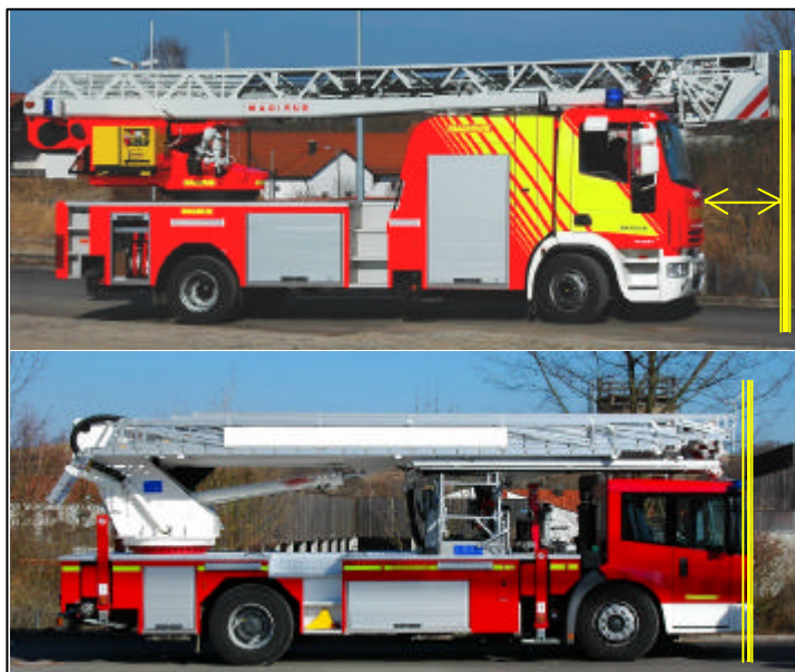
Bild 16: Oben: Drehleiter (Korbüberstand) Unten: Teleskopgelenkmast: Ausleger endet bündig mit Fahrzeugfront
