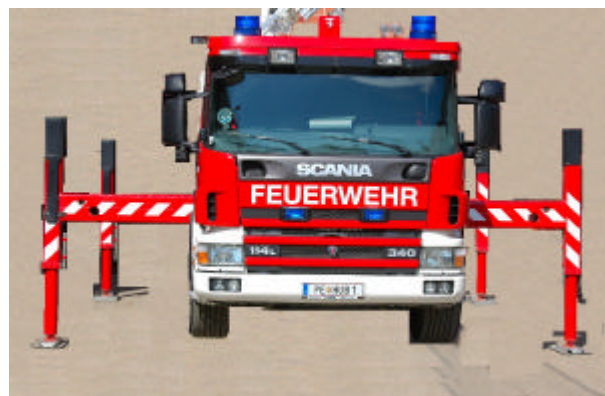
Bild 25: Wuchtige Stützen des Teleskopgelenkmasts
