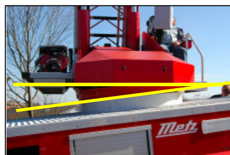
Bild 26: Niveaueingleich der Drehleiter im Drehturm
