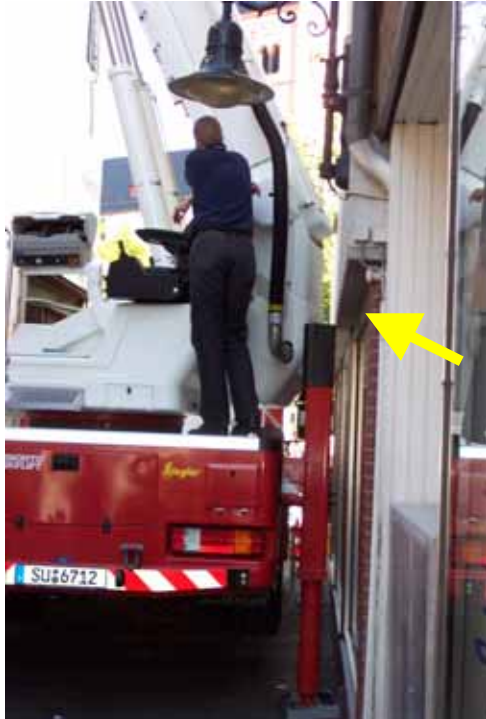
Bronto, geringer Überhang am Drehkranz
