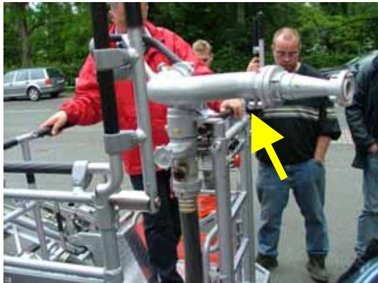
Metz, Wasserwerfer muss erst Angebaut werden
