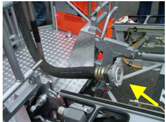
Metz, Löschwassereinspeisung verläuft über den Leiterpark
