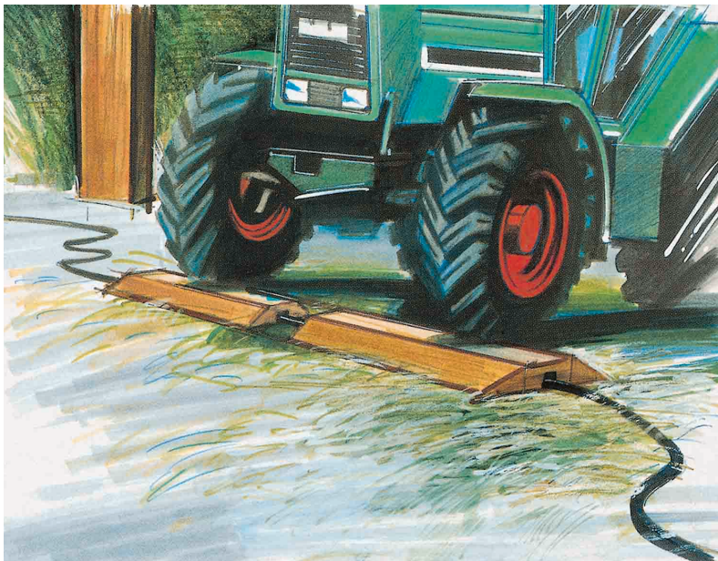
Abb. 7 - Korrekte Schutzvorrichtung für ein Elektrokabel
